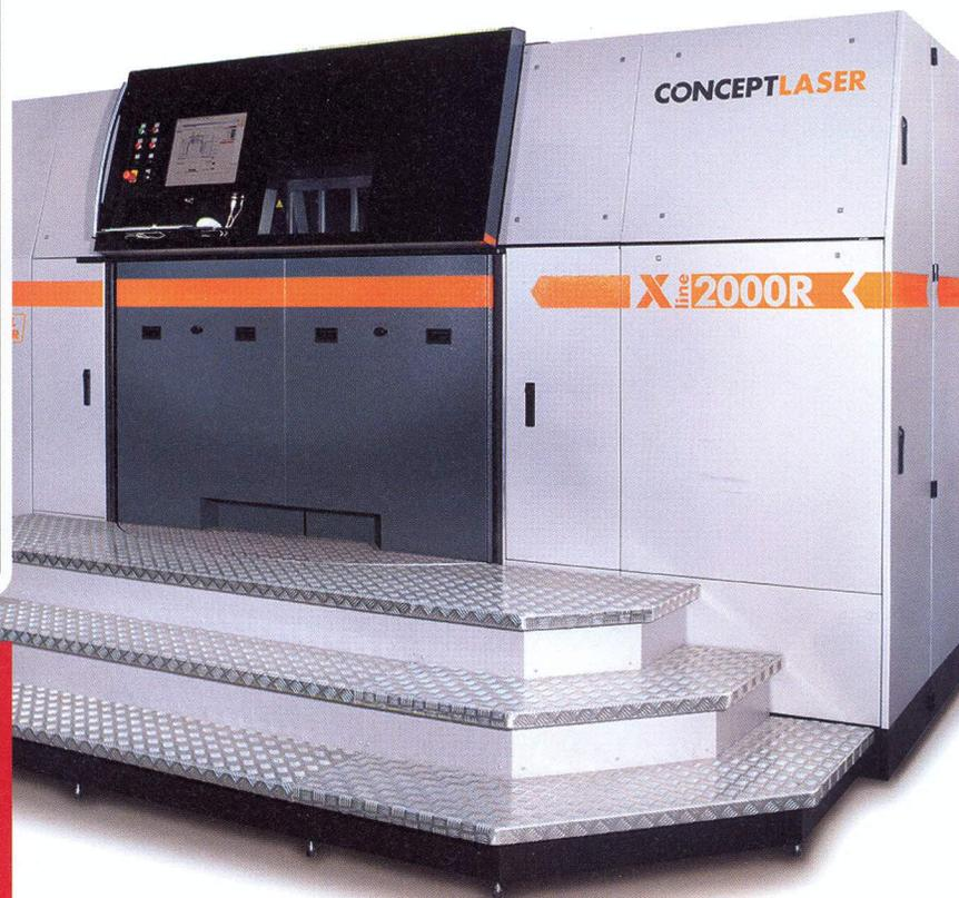
**oben** Additive Herstellung der NextGen Spaceframe Knoten auf einer X line 1000R von Concept Laser (Bauraum: 630 x 400 x 500 mm<sup>3</sup>). (Bildquelle: Concept Laser)
