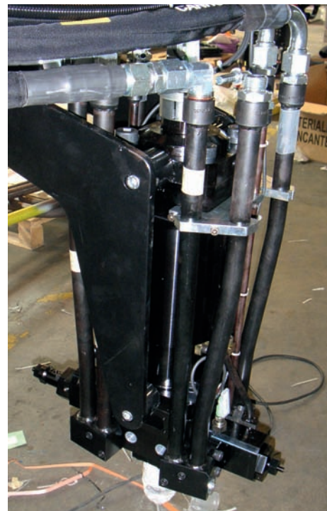
Multitalent unter den Mischköpfen: Cannon Doppel-Mischkopf FP2L32-AN
