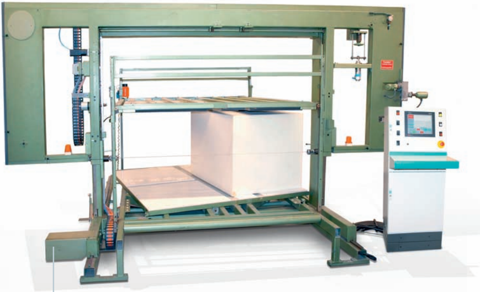
Retrofit rechnet sich: Modernisierte Schaumstoffschneidemaschine von sitola
