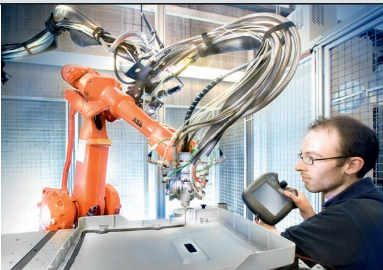
Ein Roboter mit 2K-Mischkopf trägt die PUR-Dichtung konturgenau und reproduzierbar auf
