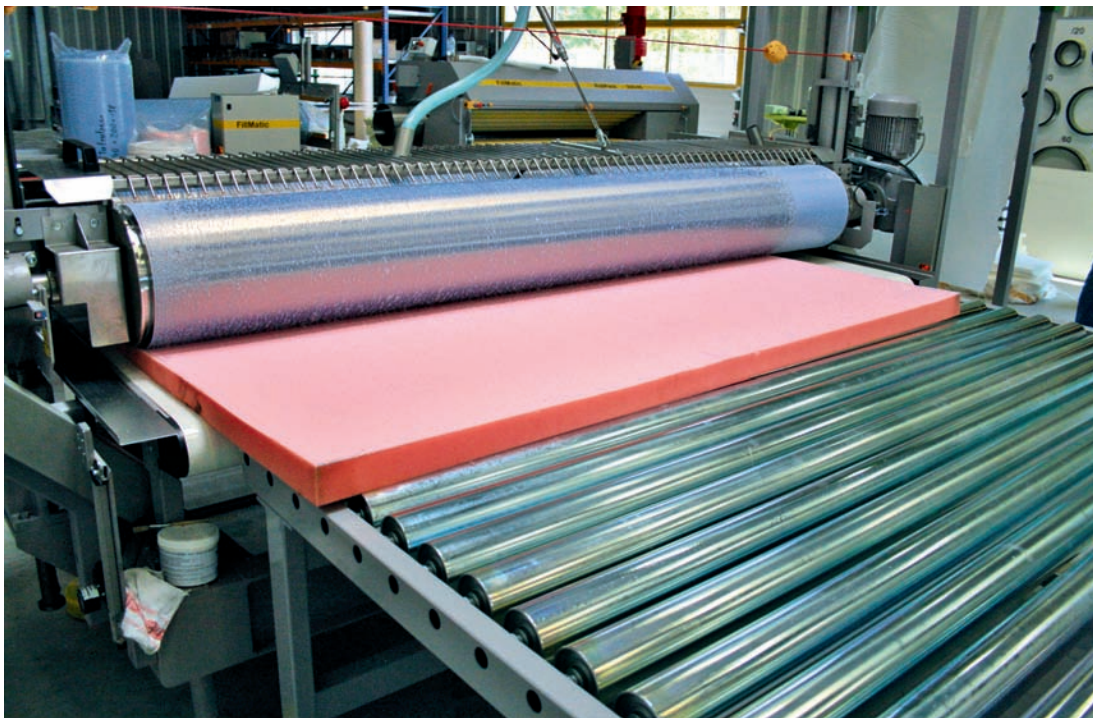
Walzenautomaten von ALFA sorgen für hohe Verarbeitungseffizienz in der Matratzenfertigung.
