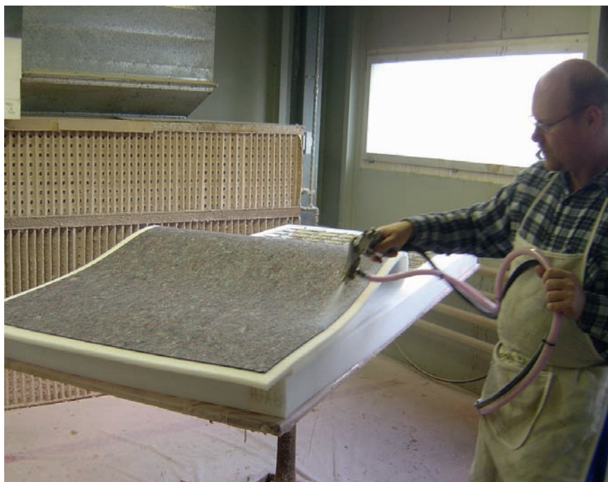
Wasserbasierende, lösungsmittelfreie Klebstoffe von ALFA sind im Sprühauftrag sparsam und umweltfreundlich
