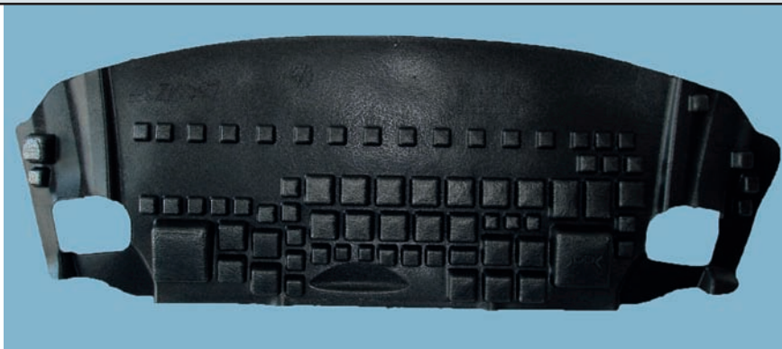
Lärm dämmen: Die einzelnen Kammern des Kammerabsorbers reduzieren gezielt Geräusche in unterschiedlichen Frequenzbereichen.
