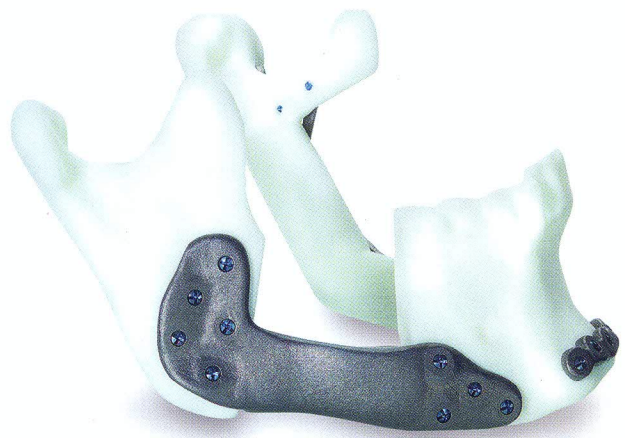
Hohe Passgenauigkeit: Additiv gefertigtes, kraniomaxillofaziales, patientenindividuelles Implantat
